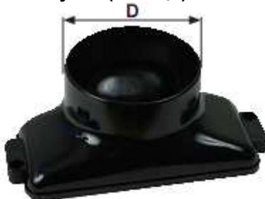
Кольцо для соединения шланга доступно в трех различных размерностях: 48, 68 и 78 мм внешний диаметр (D). Кольцо установлено на заборе воздуха на месте, где сетка прикрепена в стандартной модели.
